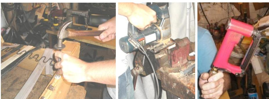
Figuras (7) Válvula de caminhão para auxiliar na fixação do selinho na estrutura de madeira do sofá; (8) Corte com a serra Tico-Tico; (9) Grampeador de ar comprimido
