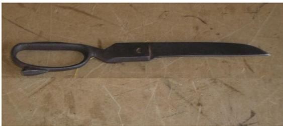
Figura 3 – Metade de uma tesoura adaptada para retirar grampos dos estofados
