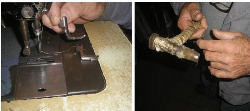
Figuras (13) Pé de máquina de costura adaptado para fazer uma costura mais justa; (14) Martelo feito com parafusos de caminhão e uma barra de ferro
